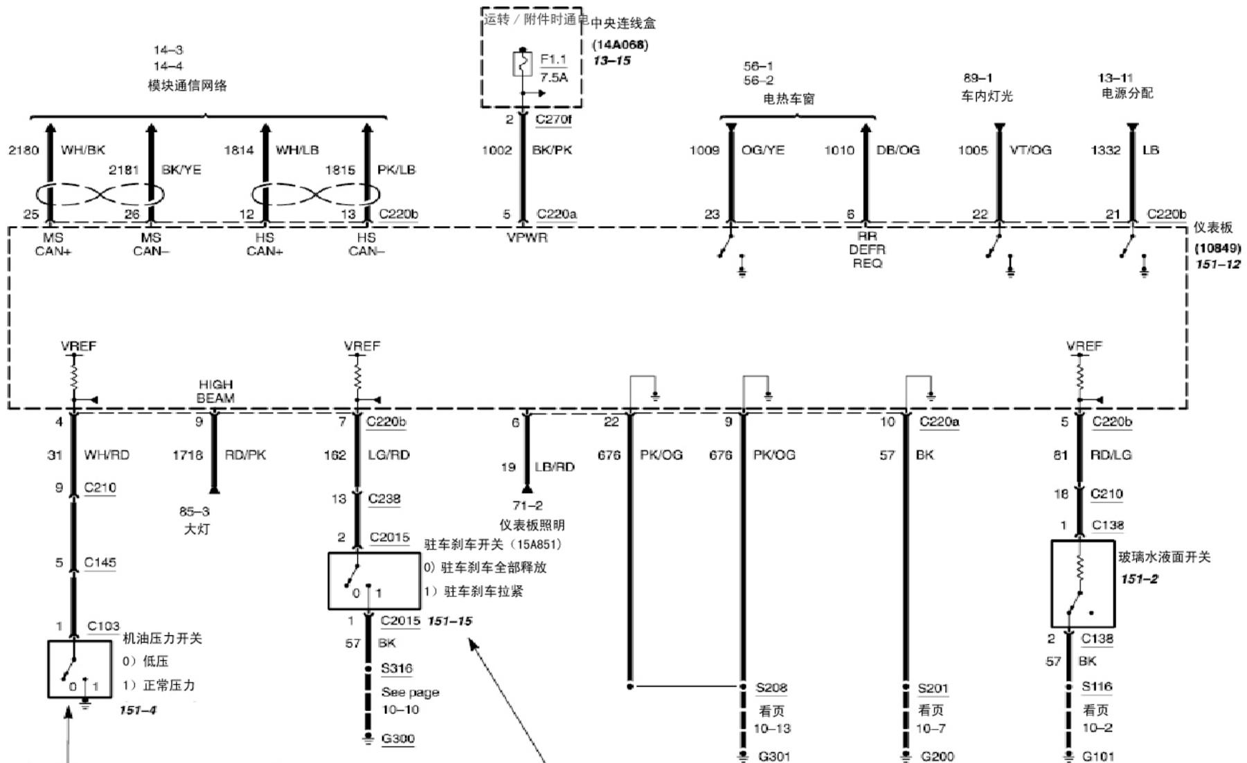
机油压力正常时闭合，压力表指示正常
